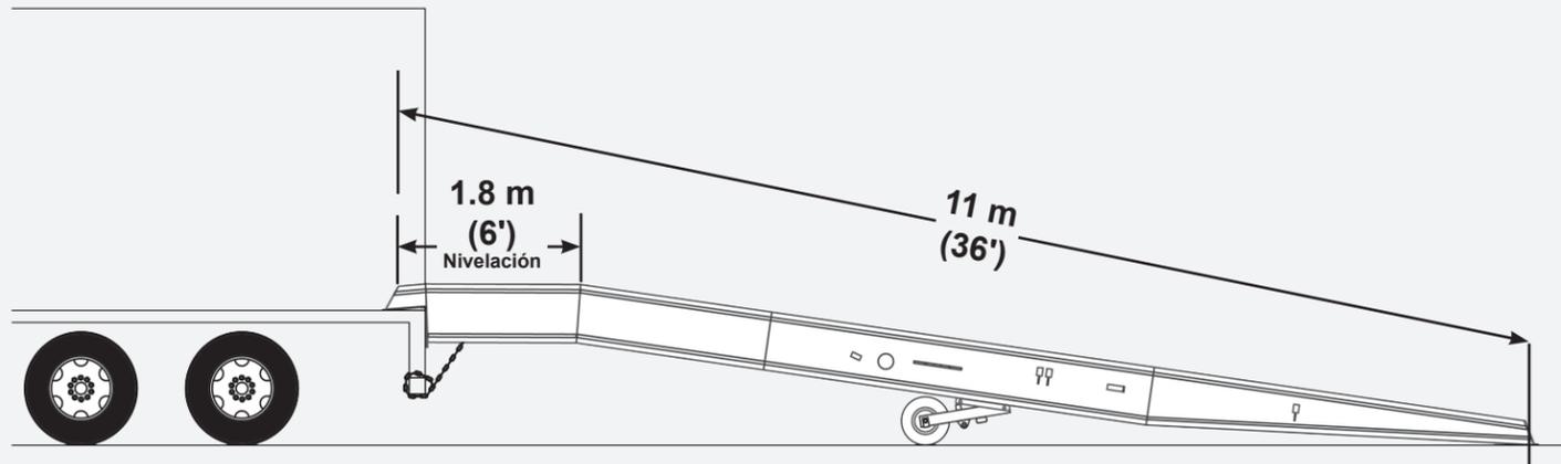
Nota: Las camas de camión típicas de 122 a 132 cm (48 a 52") equivalen a una pendiente de rampa de  $\pm 14\%$
