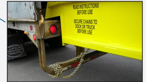
Las cadenas de seguridad afirman la rampa en el vehículo de transporte y garantiza que se mantenga un agarre adecuado del reborde con la cama del vehículo de transporte.
